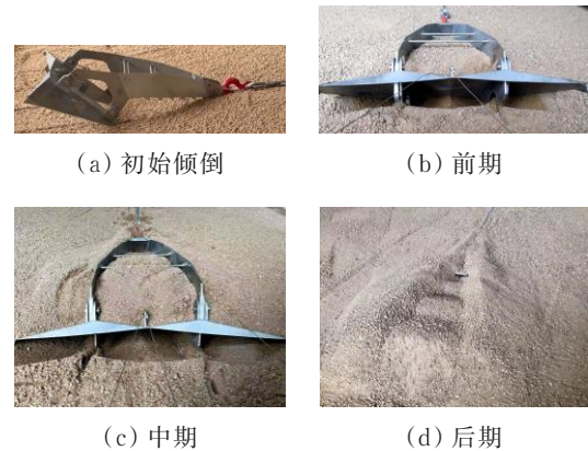
图 4 模型锚 1 的安装过程
